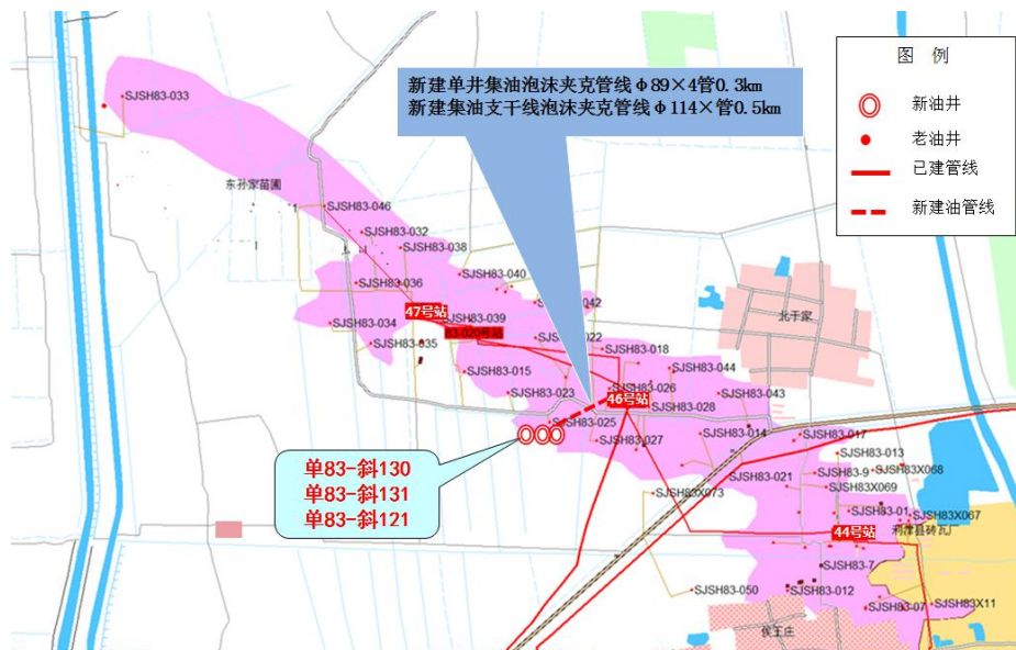
图 2.6-1 井网完善调整方案集输管网图
